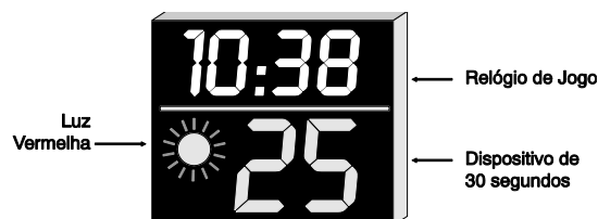
Diagrama 10 - Relógio de jogo e dispositivo de 30 segundos para as Mais Importantes Competições Oficiais da FIBA.
